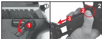
SEMPRE mantenha o equipamento apontado para uma direção segura. Coloque a trava de segurança (1) para baixo na posição ativada (travada).
