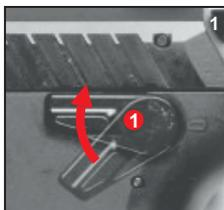
Para utilizar o equipamento certifique-se que o seletor esteja destravado, na posição FIRE.
