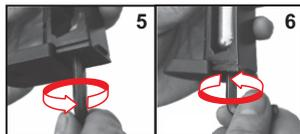
Solte o parafuso de aperto (6) girando no sentido anti-horário até que tenha espaço para poder inserir a cápsula. Insira a mesma, acomodando primeiramente a parte superior (bico) e depois a parte inferior. Finalize girando o parafuso de aperto (2) no sentido horário até romper o lacre. Aperte somente o suficiente para dar a vedação. Recoloque a capa da empunhadura na posição original.
