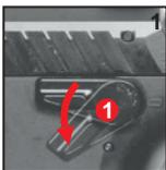
SEMPRE mantenha o equipamento apontado para uma direção segura. Coloque a trava de segurança (1) na posição S Safe/travada.
