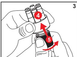
Com as munições no carregador rápido (4) pressione a haste do carregador (5) para cima e gire no sentido horário para travar a munição.
