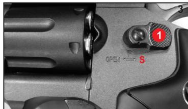
Após terminar de efetuar os disparos, coloque a trava de segurança (1) na posição "S" (Safe - travado) e pode manusear o equipamento com segurança.
