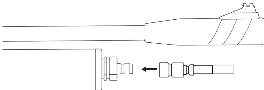
3. Conecte a mangueira do carregador (engate rápido) na válvula do cilindro de ar.
