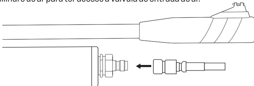
3. Conecte a mangueira do carregador (engate rápido) na válvula do cilindro de ar.
