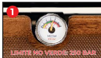
1 Lentamente e cuidadosamente bombeie até o manômetro marcar 250 BAR (3625 PSI). Controle a pressão nos dois manômetros: da carabina e da bomba manual. **ATENÇÃO: Não atire com a arma quando a pressão estiver abaixo de 75 BAR.**
