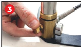
3 Feche a válvula de alívio na base da bomba pneumática manual.
