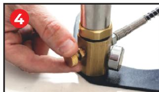
4 Assim que alcançar a pressão desejada, abra a válvula de alívio. Você irá escutar um som de ar vazando de um pequeno orifício. Após isto, remova com cuidado a mangueira do bico de engate rápido da válvula de recarga de ar. **MANTENHA OS PONTOS DE CONEXÃO SEMPRE LIMPOS.**
