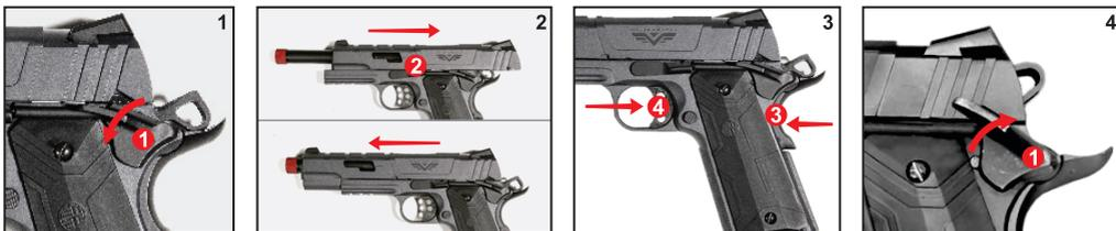
Para utilizar o equipamento coloque a trava de segurança (1) para baixo para destrava-la.
