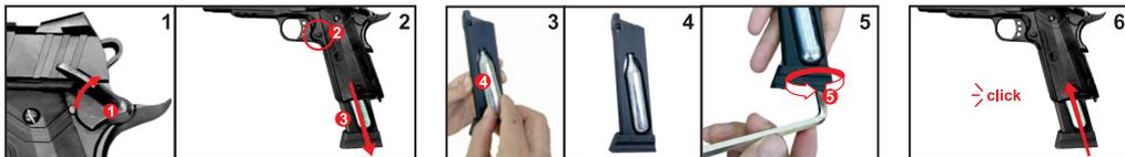
SEMPRE mantenha o equipamento apontado para uma direção segura. Coloque a trava de segurança (1) para cima, na posição ativa (travada).
