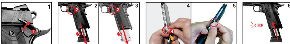
SEMPRE mantenha o equipamento apontado para uma direção segura. Coloque a trava de segurança (1) na posição safe / travada.
