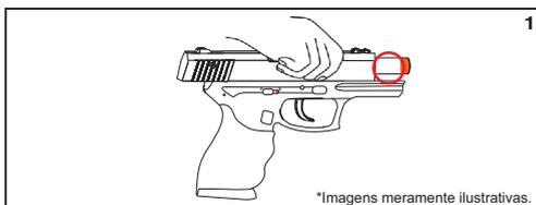
Use óleo de silicone puro (nunca use qualquer outro tipo de óleo) que deve ser aplicado nos locais circulados em vermelho. Coloque duas ou três gotas na parte externa do cano para facilitar o deslocamento do slide sobre o cano.
