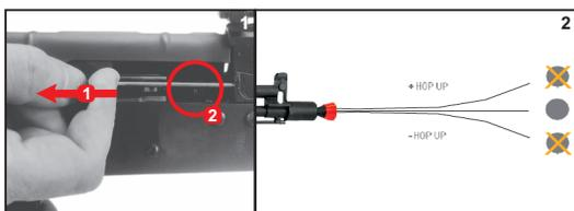
O hop up é um sistema de peças que tem como função ajustar a trajetória vertical da munição. Para regula-lo puxe e segure para trás a alavanca de manejo (1) para poder ter acesso à alavanca interna de regulagem do hop up (2).
