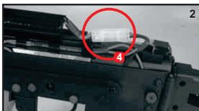
Ligue o conector na bateria e posicione-a com cuidado de modo a comportar a fiação, conector e bateria dentro do compartimento. Cuidado para não danificar a fiação ao fechar a tampa. Assista ao vídeo tutorial acessando o QR CODE abaixo.
