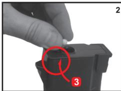
Para municiar o carregador, insira as esferas pelo topo (3) e encha o compartimento com a munição recomendada;
