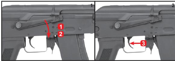
Seu rifle possui dois modos de disparo: semiautomático e automático. Para selecionar o modo automático, coloque a chave conforme a posição 1. Obs.: Para conservação e melhor performance do equipamento não pressione o gatilho por mais de 3 segundos. Já para selecionar o modo semiautomático, coloque a chave conforme a posição 2. Selecione o modo de disparo desejado, mire em um alvo seguro e aperte o gatilho (3).
